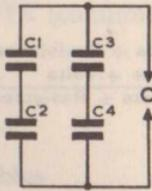
$C = \frac{I}{\frac{I}{C_1+C_2} + \frac{I}{C_3+C_4}}$                                                         |
