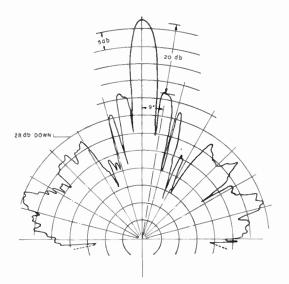
Fig. 5.—Horizontal polar diagram.
