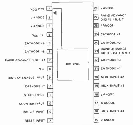
Fig. 1. Pinout.
