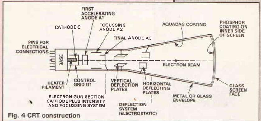
Fig. 4 CRT construction
