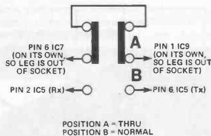
Fig. 5 Wiring the optional 'THRU' switch
