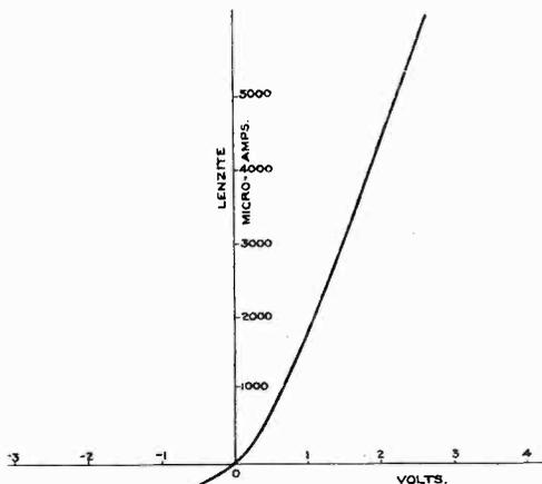
Fig. 5. (c.) Lenzite Crystal Rectifier.
