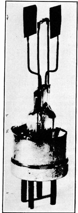
Fig. 2. *Internal construction of the rectifier.*
