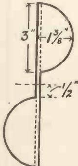
Fig. 7.—The Propeller.
