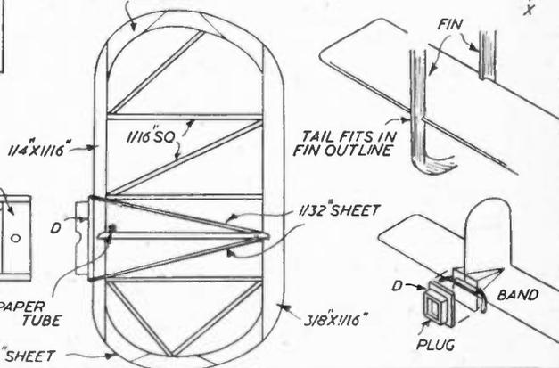
CUT PLAN AND REJOIN FUSELAGE ALONG LINES X-X
