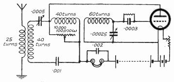
FIG. 2.- THE SUPER-SELECTIVE CIRCUIT
