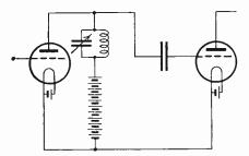
FIG. 3 .- TUNED ANODE COUPLING
