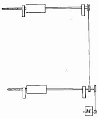
FIG. 2a .- SHOWING SYNCHRONIZER DRUMS
