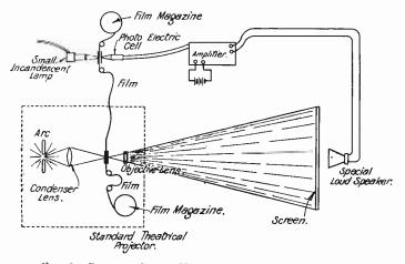
FIG. 6.-DIAGRAM SHOWS HOW THE SOUND IS REPRODUCED
