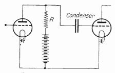
FIG. 1.—RESISTANCE COUPLING
