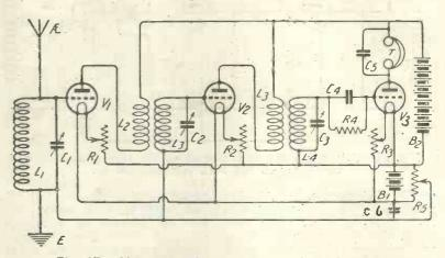
Fig. 37 .- Circuit utilising potentiometer control;
