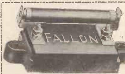
**FIXED CONDENSER WITH GRID LEAK COMBINED.**
