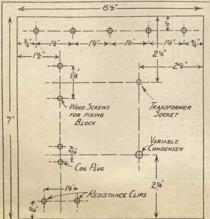
FIG. 2. DRILLING LAYOUT (FRONT OF PANEL)
