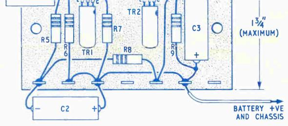
FIG. 3 - AMPLIFIER PANEL WIRING
