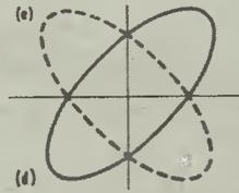
Fig. 2. Basic Lissajous patterns indicating phase differences (a) 0° (360°), (b) 180°, (c) 90° or 270°, (d) 45° or 225°, (e) 135° or 315°
