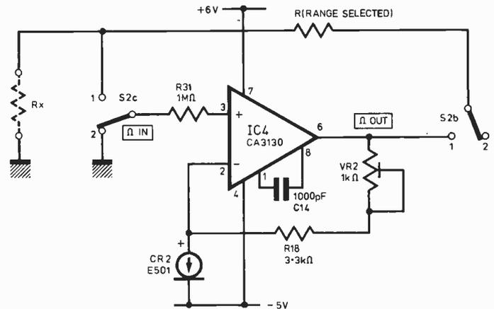
Fig. 4. Ohms Converter
