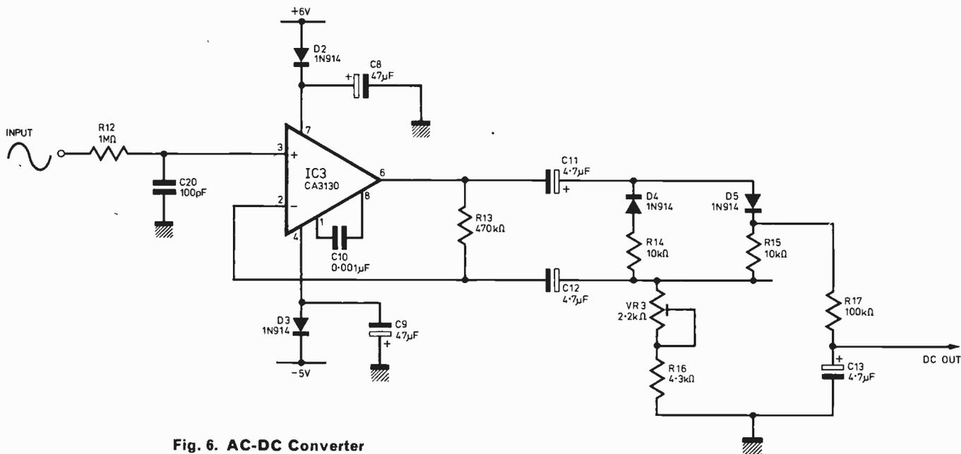
Fig. 6. AC-DC Converter
