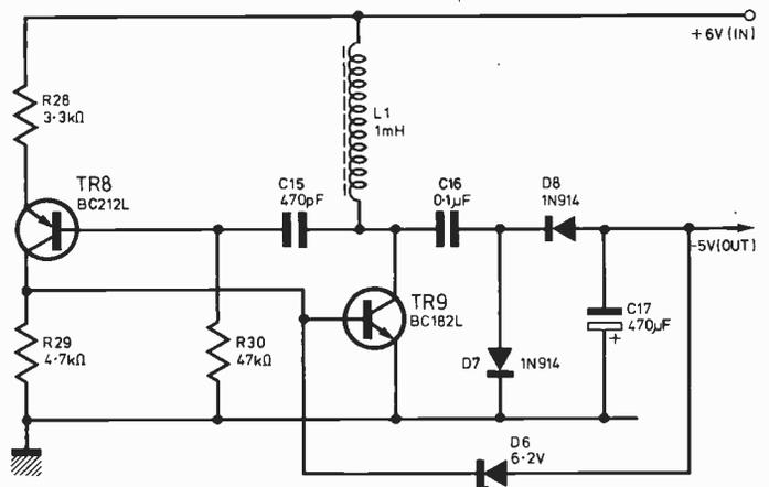
Fig. 5. DC-DC Converter
