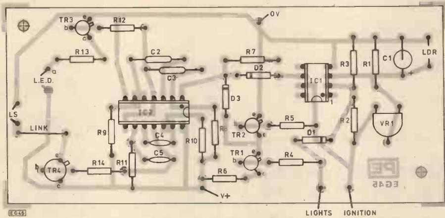
Fig. 2. Component overlay
