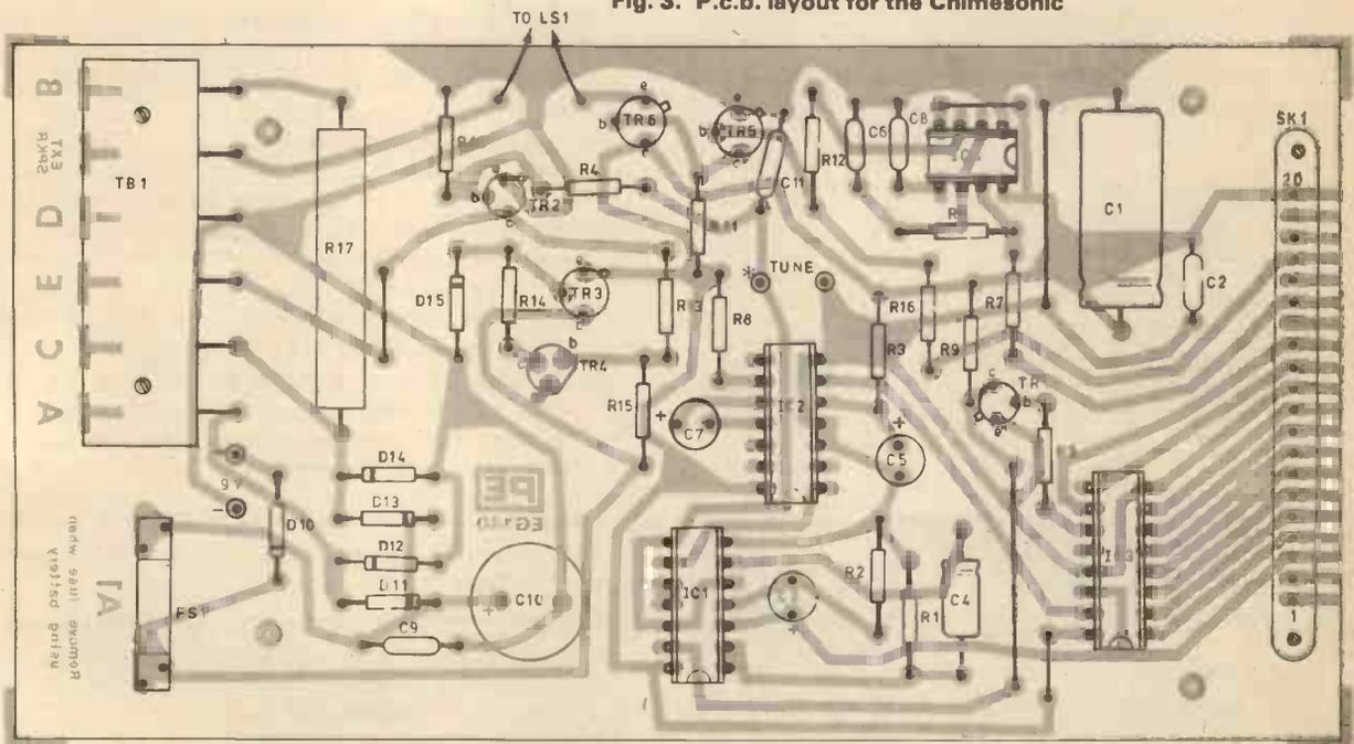
Fig. 4. Component overlay
