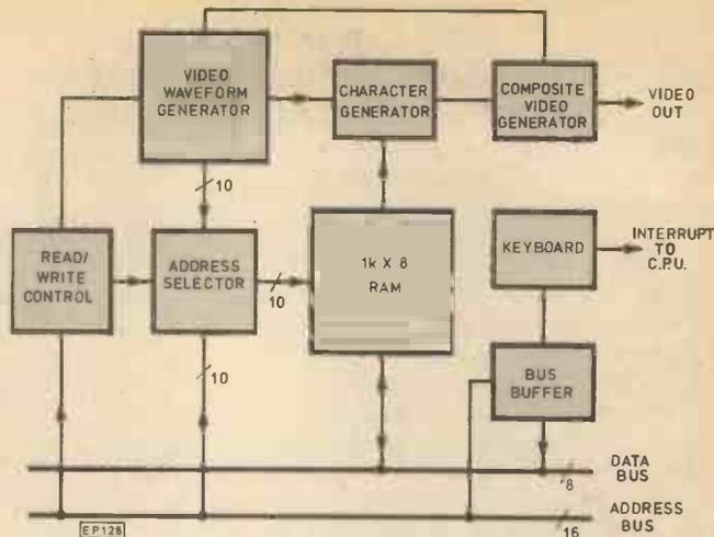
**Fig. 2. VDU block diagram**
