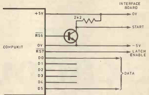
Fig. 2.9. Simple Compukit interface
