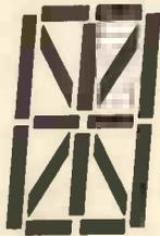
Fig. 7.3. The 16-segment display format
