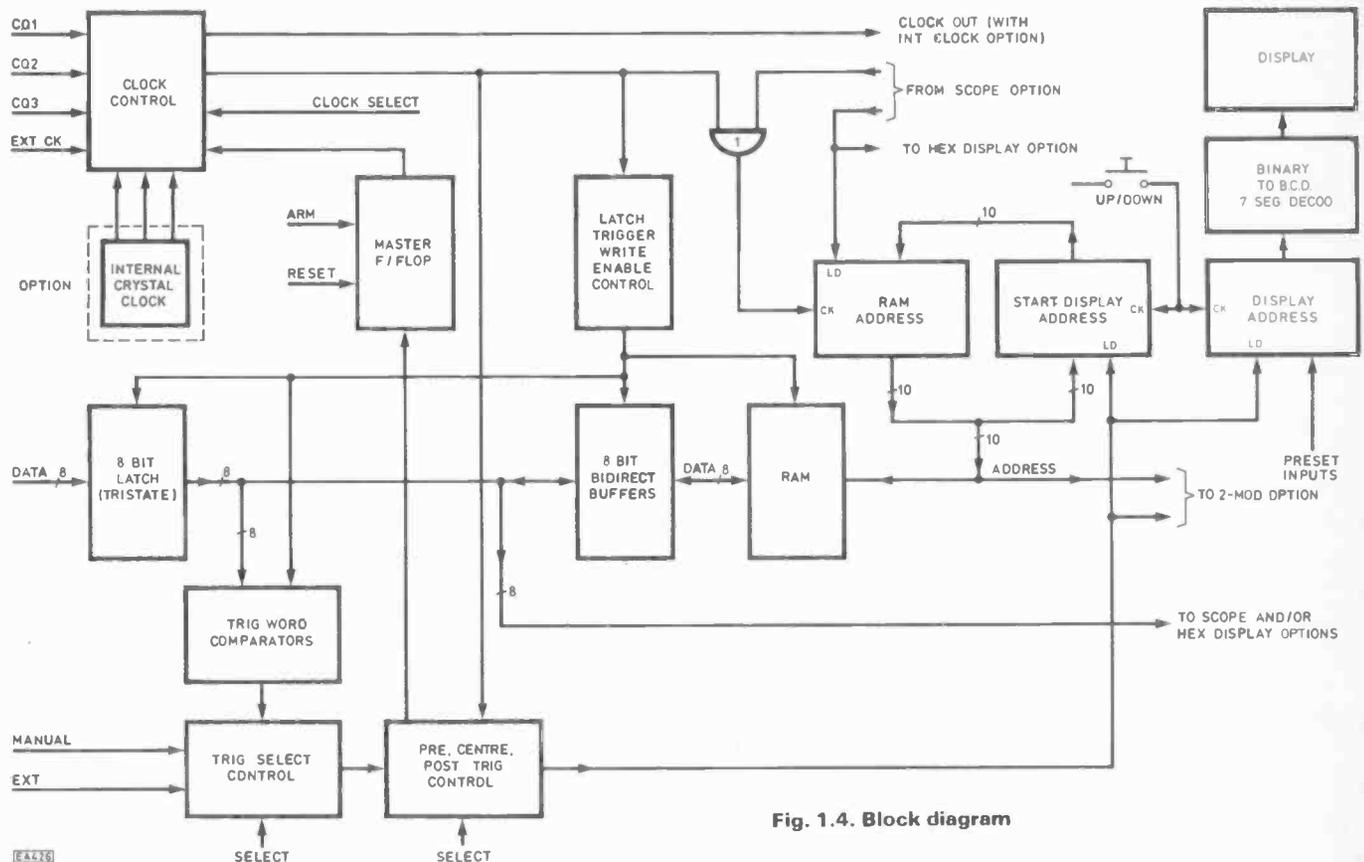
Fig. 1.4. Block diagram
