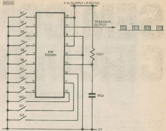
Fig. 3. I.c. in transmit mode
