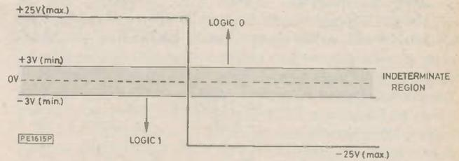
**Fig. 4. RS232 voltage levels**
