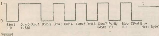
**Fig. 3. Serial data byte waveform**
