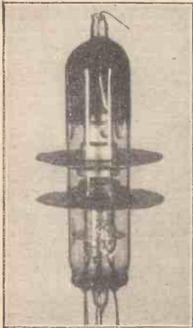
Fig. 18a.—Reflex Klystron CV116.
