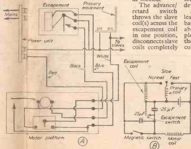
Fig. 2.—The circuit.
