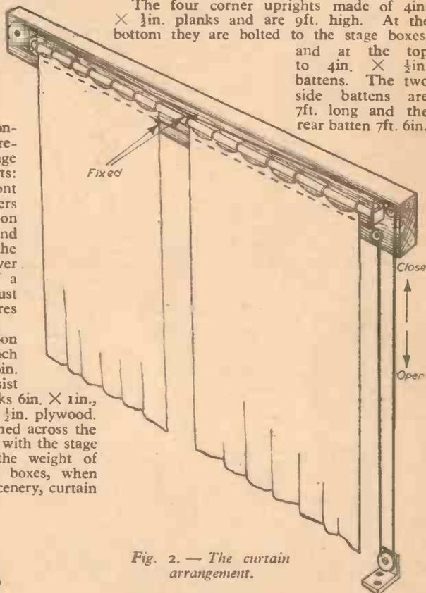
Fig. 2. — The curtain arrangement.
