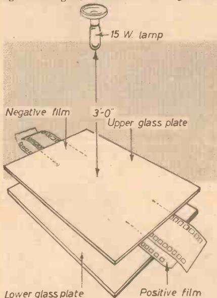
Fig. 1.—The optical arrangement.
