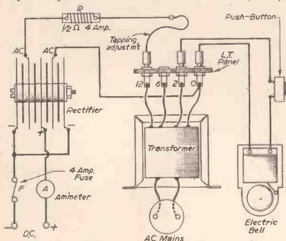
Fig. 1.—Wiring diagram.
