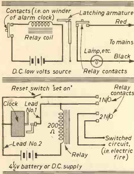
Fig. 46 (Top).—Time switch relay system.
