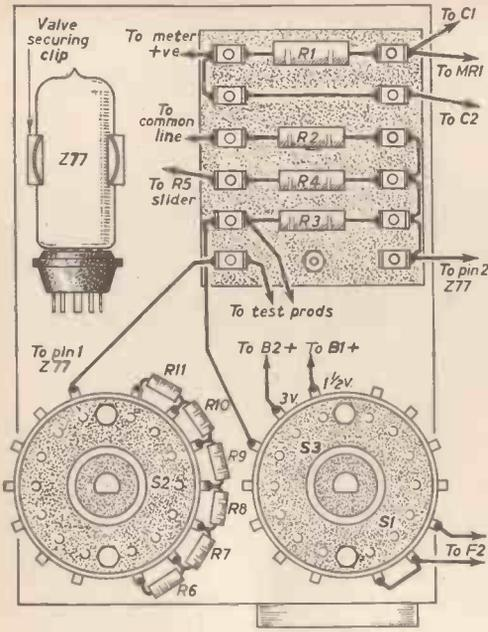
Fig. 3.—Wiring the actual lie detector.
