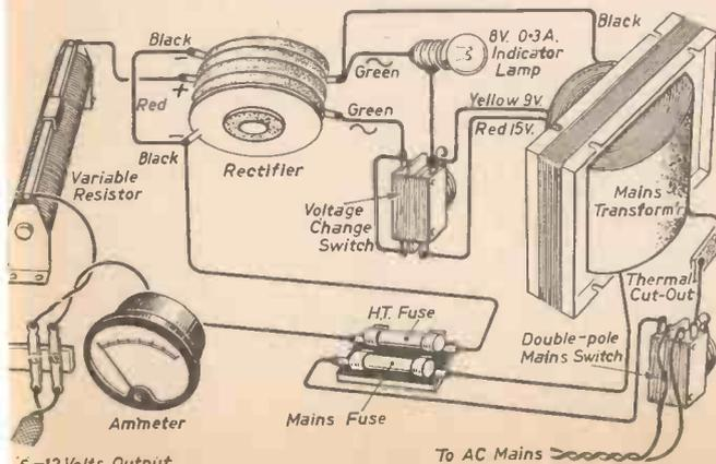
Fig. 5.—Wiring diagram.
