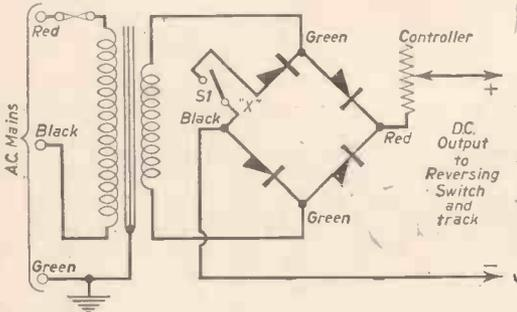
Fig. 1.—Basic transformer rectifier unit.
