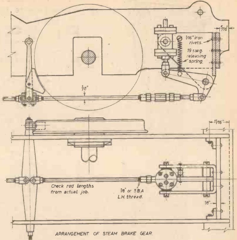
ARRANGEMENT OF STEAM BRAKE GEAR.
