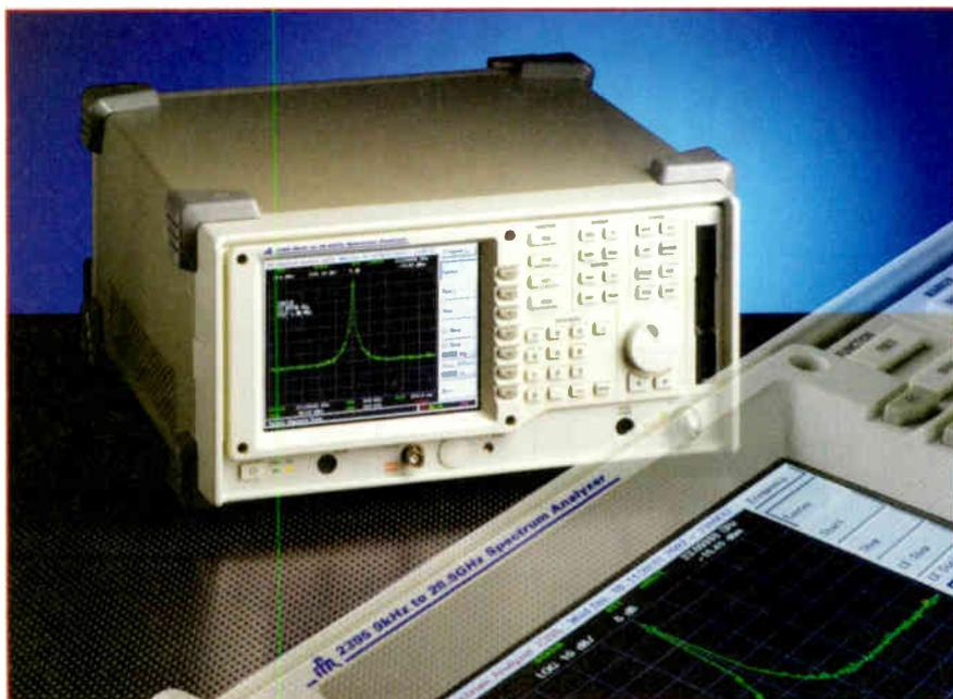
*Aeroflex 2395 spectrum analyser*
