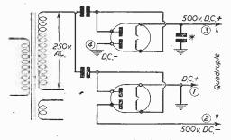
Fig. 3.-A simple quadrupler circuit.
