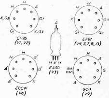
Fig. 9.---Valve-base data.
