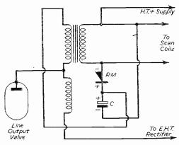
Fig. 11.-A recovery diode circuit.
