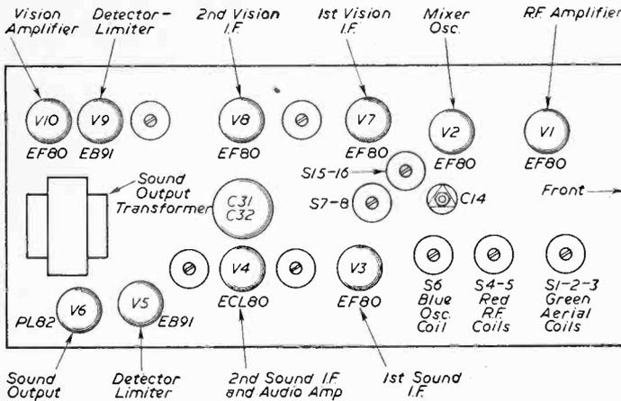
Fig. 4.—Chassis layout.
