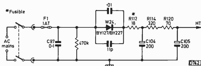
Fig. 1: Mains input/h.t. rectifier circuit.
