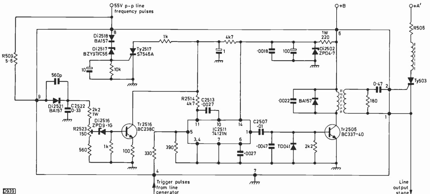
Fig. 2: E.H.T. control module circuit.
