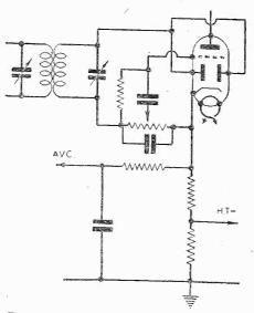
Fig. 3.—Amplified A.V.C. using a doublediode-triode.
