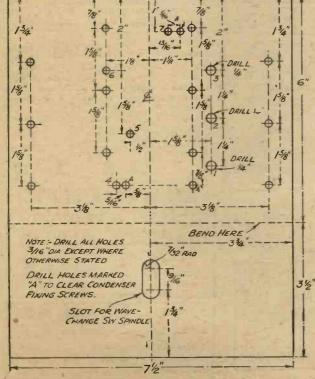
Fig. 4 .- Drilling dimensions for the chassis.
