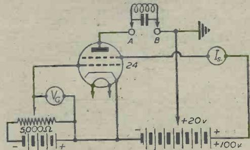
Fig. 2.—Battery-driven dynatron.
