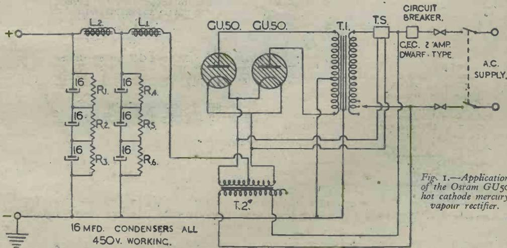
Fig. 1.—Application of the Osram GU50 hot cathode mercury vapour rectifier.
