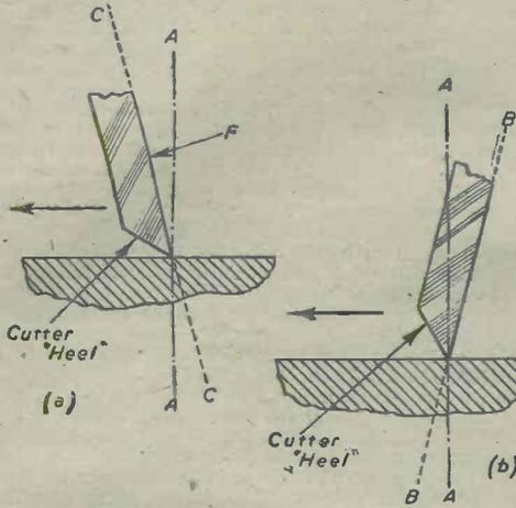
Fig. 1.—Measuring the heel angle.
