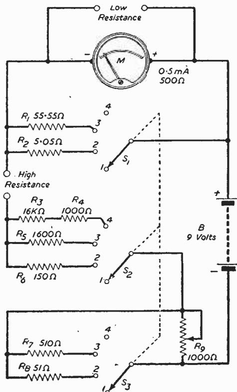
Fig. 3.—The wide-range ohmmeter for 0.1 ohm—1 megohm.
