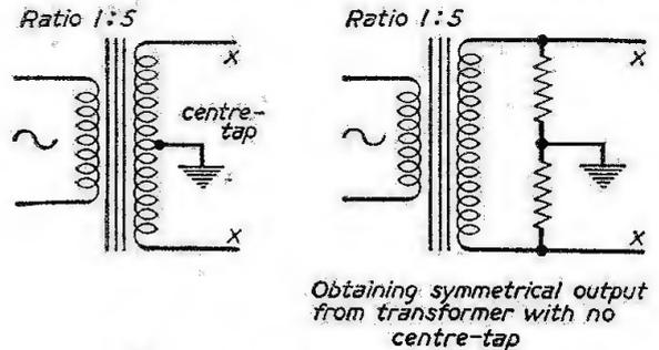
Fig. 4.—L.F. transformer data.
