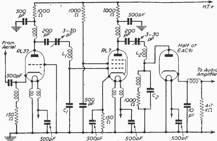
Fig. 49.—A V.H.F. converter.
