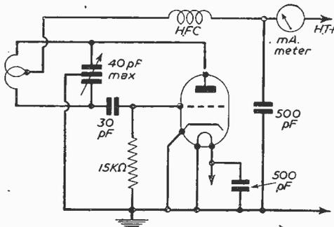
Fig. 55.—A V.H.F. test oscillator.
