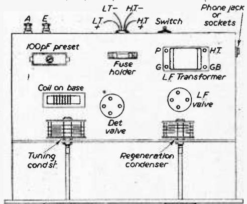
Fig. 3.—Component lay-out.
