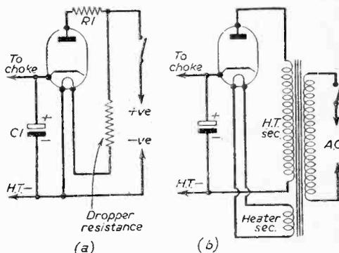
Fig. 5.—Using a valve rectifier.
