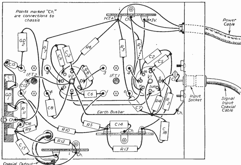
Fig. 16.—Wiring diagram for Fig. 14.
