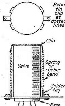
Fig. 9.—Valveholder clips.
