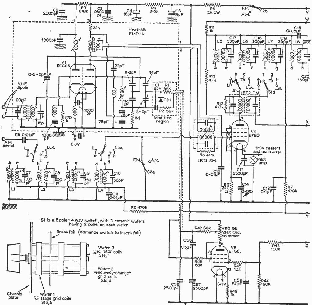
Fig. 9a: The r.f. and a.f.c. stages of the circuit.
